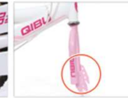
7. De voorvork in de goede Richting zetten
