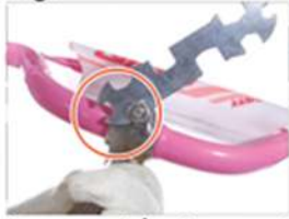
13. Het stuur recht zetten en vastdraaien
