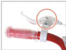
18. Plaats de remkabel in de handrem en zet deze vast door de stelbout te verdraaien.
