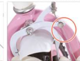
20. Knijp de voorrem bij mekaar trek de remkabel aan en draai de bout aan.
