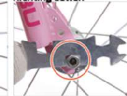
12. Stangetjes aanbrengen van voorspatbord daarna de bouten aanbrengen en geleidelijk aandraaien.
