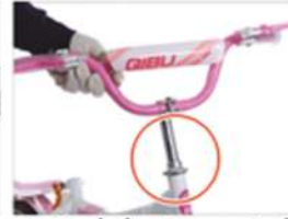
15. Steek de stuurpen in het frame en draai daarna de bout geleidelijk aan tot dat het stuurvast zit.
