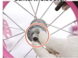
8. Het voorwiel plaatsen in de voorvork. LET OP zorg dat je hem er altijd recht en in het midden inhangt.
