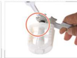
19. Let op je hebt een linker en een rechtertrapper. Trappers aandraaien en vast is vast.
