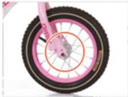
8. Het voorwiel plaatsen in de voorvork. LET OP zorg dat je hem er altijd recht en in het midden inhangt.
