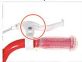
18. Plaats de remkabel in de handrem en zet deze vast door de stelbout te verdraaien.
