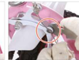
20. Knijp de voorrem bij mekaar trek de remkabel aan en draai de bout aan.
