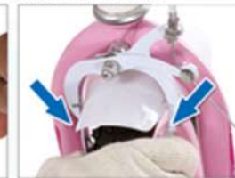
20. Knijp de voorrem bij mekaar trek de remkabel aan en draai de bout aan.
