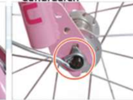
12. Stangetjes aanbrengen van voorspatbord daarna de bouten aanbrengen en geleidelijk aandraaien.
