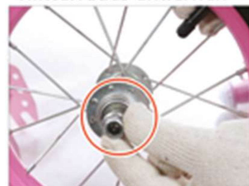
8. Setzen Sie das Vorderrad in die Vorderradgabel ein. HINWEIS Achten Sie darauf, dass Sie es immer gerade und in der Mitte einhängen.
