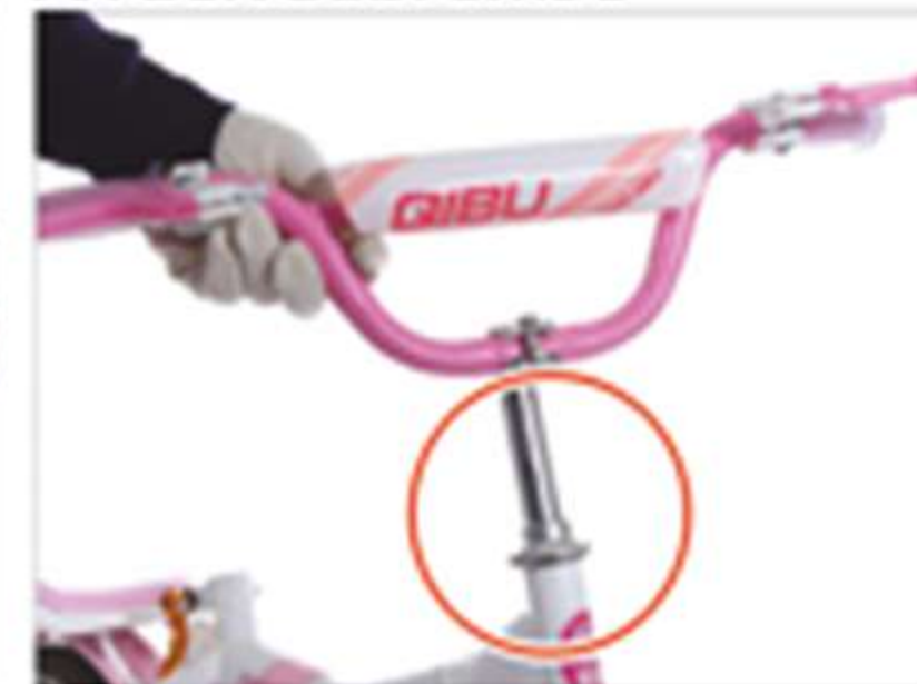
15. Setzen Sie den Vorbau in den Rahmen ein und ziehen Sie die Schraube schrittweise an, bis sie fest sitzt
