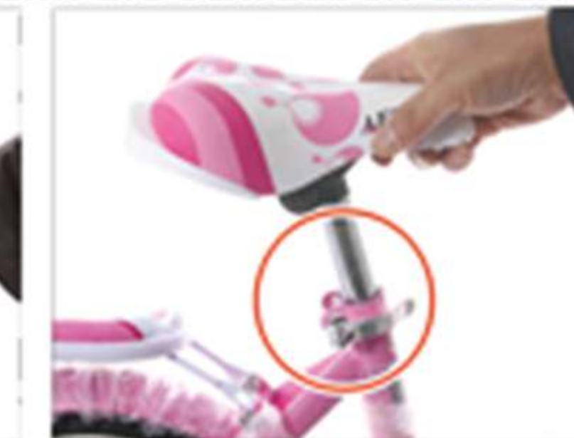
17. Führen Sie die Sattelstütze in den Rahmen ein und ziehen Sie sie fest.
