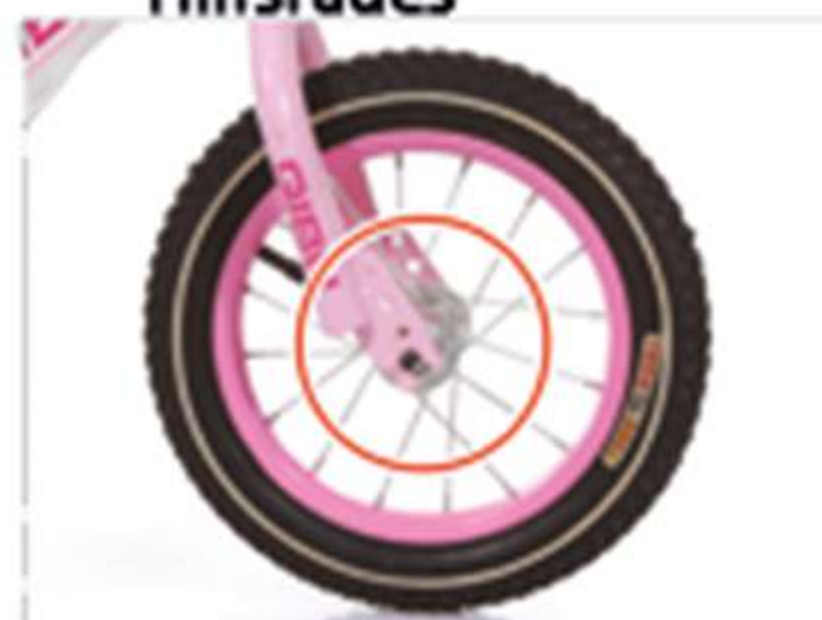
8. Setzen Sie das Vorderrad in die Vorderradgabel ein. HINWEIS Achten Sie darauf, dass Sie es immer gerade und in der Mitte einhängen.
