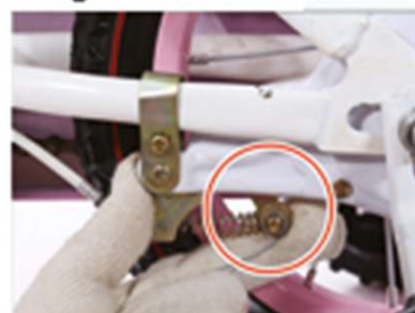
18. Führen Sie das Bremsseil in die Handbremse ein und befestigen Sie es durch Drehen des
