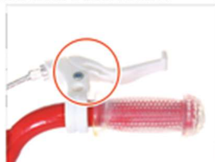
18. Führen Sie das Bremsseil in die Handbremse ein und befestigen Sie es durch Drehen des
