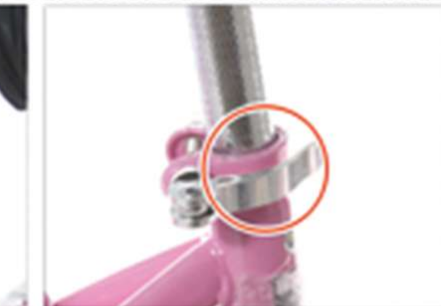
17. Führen Sie die Sattelstütze in den Rahmen ein und ziehen Sie sie fest.
