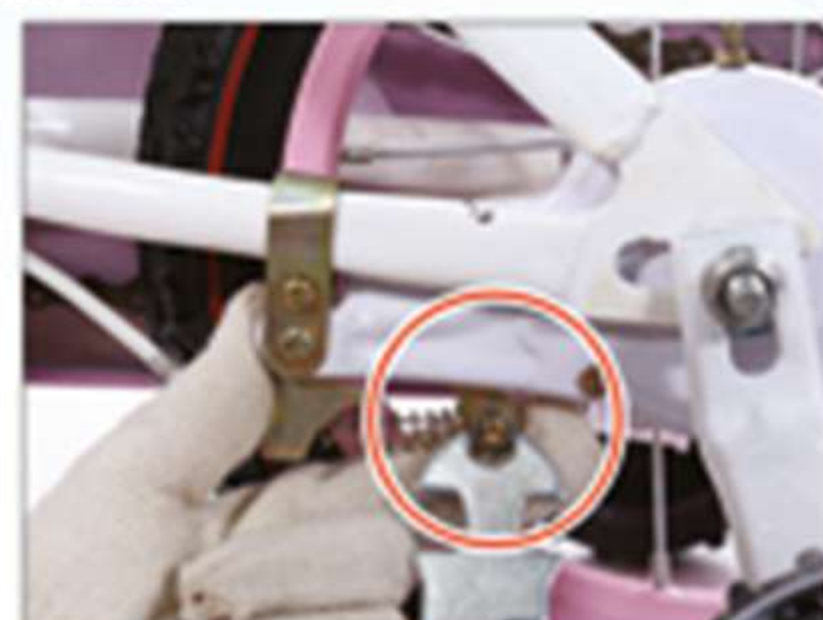
18. Führen Sie das Bremsseil in die Handbremse ein und befestigen Sie es durch Drehen des
