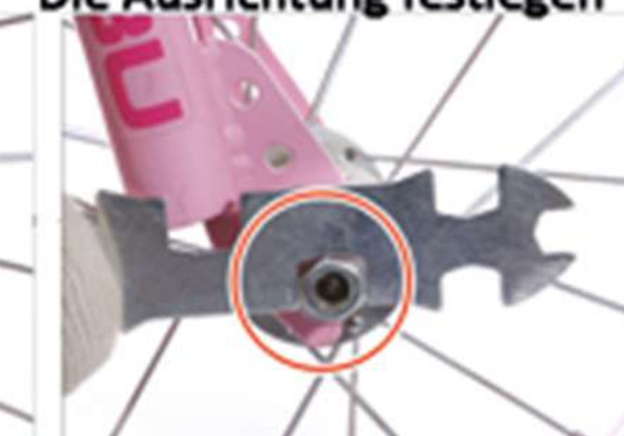
12. Installieren Sie die vorderen Kotflügelstangen, setzen Sie dann die Schrauben ein und ziehen Sie sie allmählich fest.
