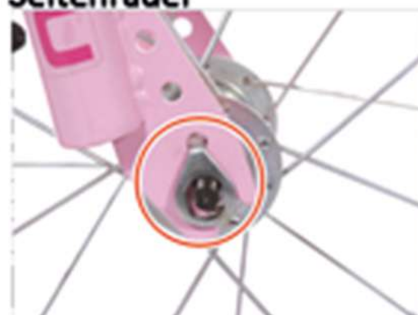
8. Setzen Sie das Vorderrad in die Vorderradgabel ein. HINWEIS Achten Sie darauf, dass Sie es immer gerade und in der Mitte einhängen.
