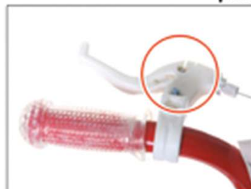
18. Führen Sie das Bremsseil in die Handbremse ein und befestigen Sie es durch Drehen des
