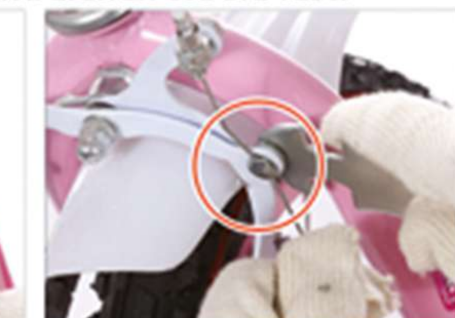
20. Betätigen Sie die Vorderradbremse, ziehen Sie das Bremskabel heraus und ziehen Sie den Bolzen
