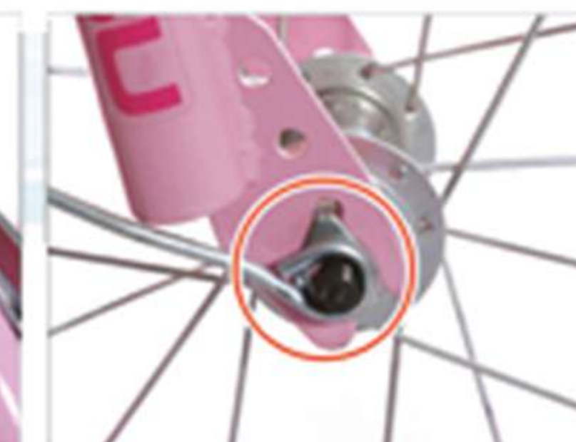
12. Installieren Sie die vorderen Kotflügelstangen, setzen Sie dann die Schrauben ein und ziehen Sie sie allmählich fest.
