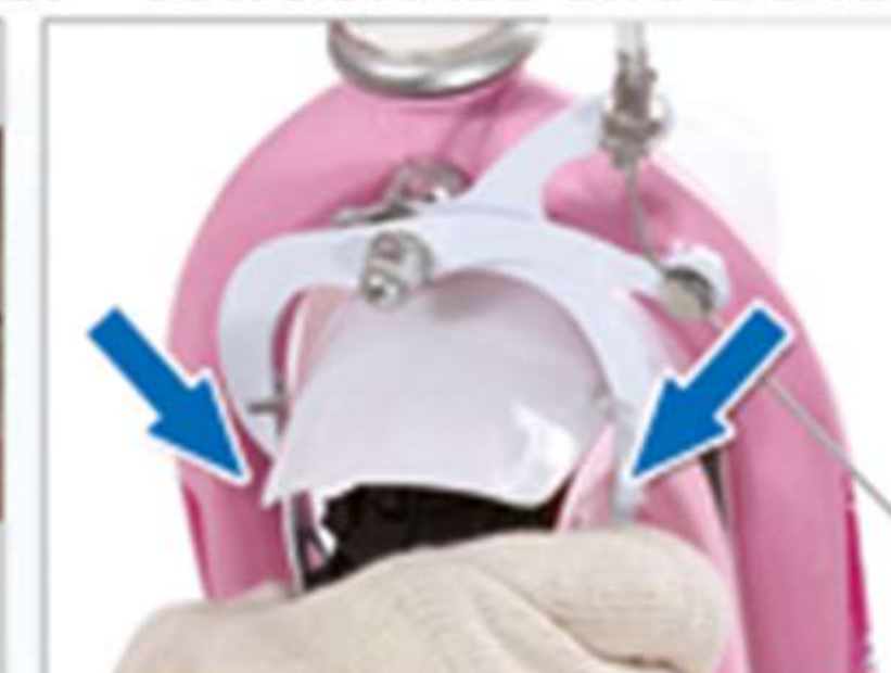
20. Betätigen Sie die Vorderradbremse, ziehen Sie das Bremskabel heraus und ziehen Sie den Bolzen
