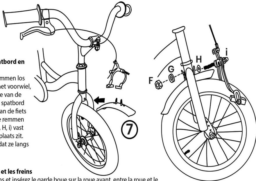
**Het monteren van het spatbord en de voorrem**
